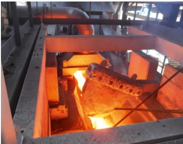
Schlackenfluss zum Granulator, Foto: Primetals Technologies
