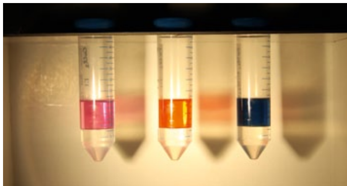
Metallionen-Extraktion aus Wasser durch hydrophobe DES (Deep Eutectic Solvents), Foto: TU Eindhoven
